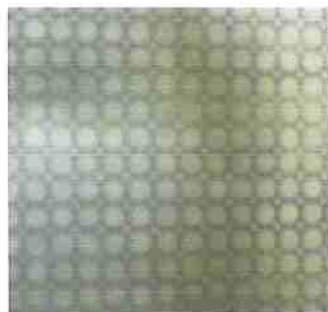
Figura 3.10 – Círculos desenhados sobre a amostra por eletro-corrosão
